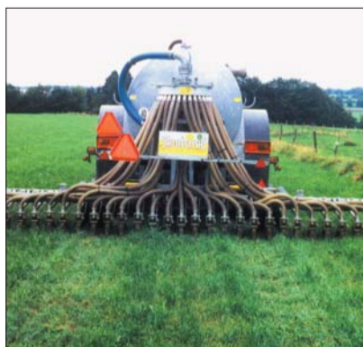
Gülleschleppschuh – Gewässer schonende Ausbringungstechnik von Dünger
